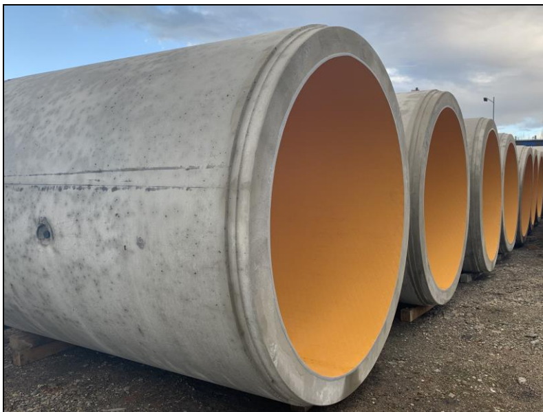
Zdjęcie 7: widok rur do metody mikrotunelowania DN2800 z zabetonowaną wykładziną PEHD, Zadanie: kolektor Lindego Bis w m. Warszawa
