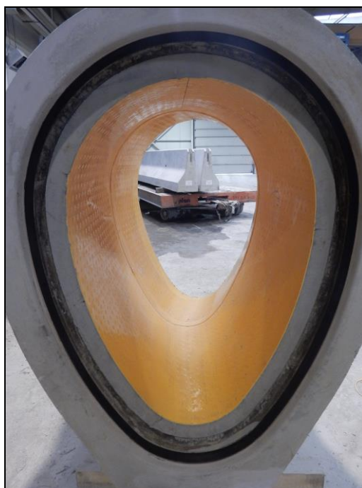
Zdjęcie 6: widok na rurę żelbetową łukową 15° o przekroju jajowym DN1000/1500 z wykładziną PEHD,
