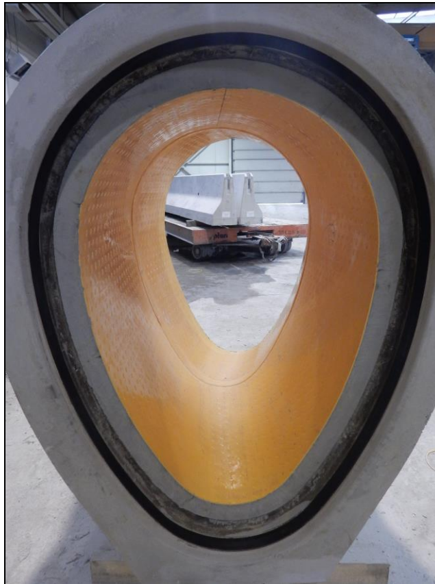
Zdjęcie 5: widok na rurę żelbetową łukową 15° o przekroju jajowym DN1000/1500 z wykładziną, widok od strony kielicha
